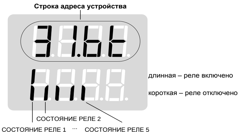
Рисунок 9 – Пример табло показывающего прибора при просмотре состояний реле БК
