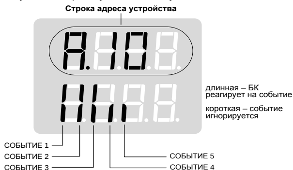
Рисунок 7 – Пример табло показывающего прибора при внесении записи в таблицу
