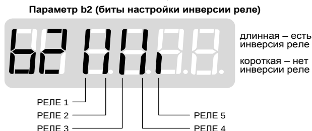
Рисунок 8 – Пример табло показывающего прибора при внесении записи параметра b2
